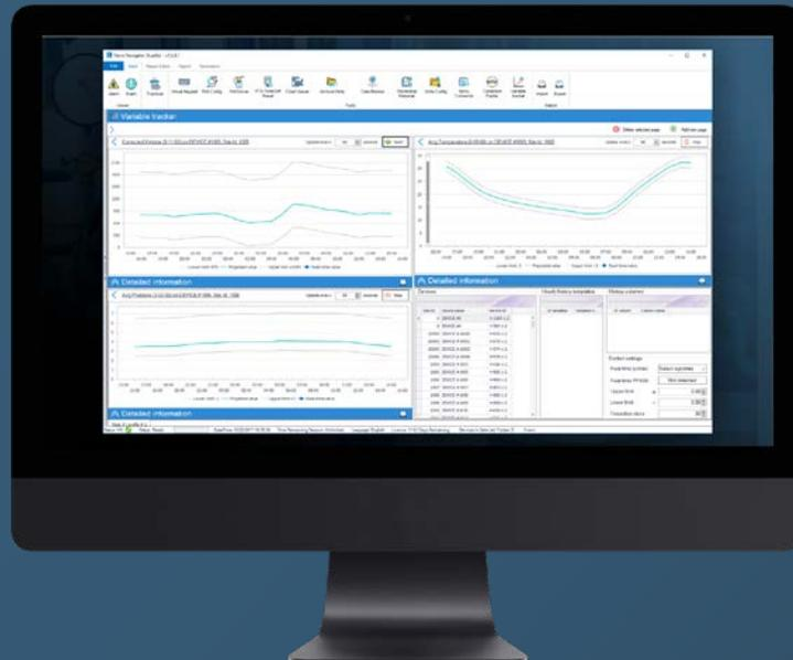
Variable Tracker es un módulo del NOVO SCADA que permite hacer seguimiento a cualquier variable operacional en tiempo real. Este seguimiento incluye una comparación constante del valor de la variable del dispositivo de medición versus su comportamiento normal proyectado para el rango horario del día en que se esta monitoreando. Esta comparación genera un desfase de comportamiento
